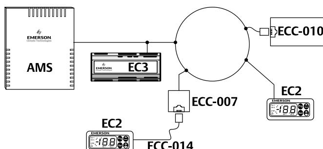
Соединение переносного компьютера с сетью LON с интерфейсом FTT10, с использованием USB переходника ECC-034 с кабелем.
