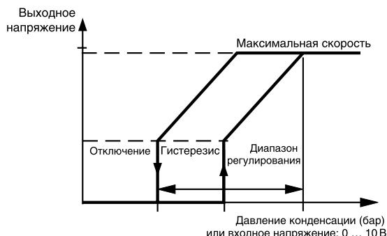
Верхний график описывает скорость вентилятора при снижении давления, нижний - при увеличении. При наивысшем давлении конденсации вентилятор работает с максимальной скоростью (справа вверху). В области регулировки скорость вентилятора снижается вместе с давлением. Если давление падает ниже установленного предела, вентилятор отключается.
