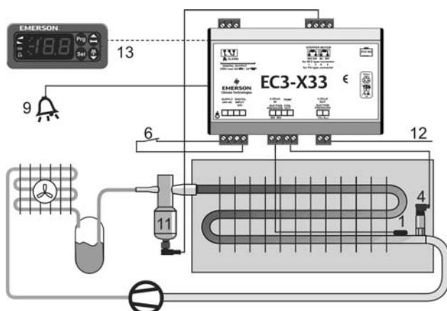
1. ECN-N60 датчик температуры трубы
